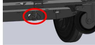
Das Gerät wird transportiert, wobei die Waage durch eine Sicherungsschraube gesperrt ist, um zu vermeiden, dass die Lastzelle beschädigt wird. Die Waagen-Sicherungsschraube befindet sich an der unteren Seite der Ausrüstung (siehe Kasten oben) und wird durch eine Schraube geformt. Zur Inbetriebnahme schrauben Sie die Schrauben ab.
