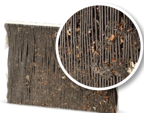
Sin mantenimiento del sistema de A/A
